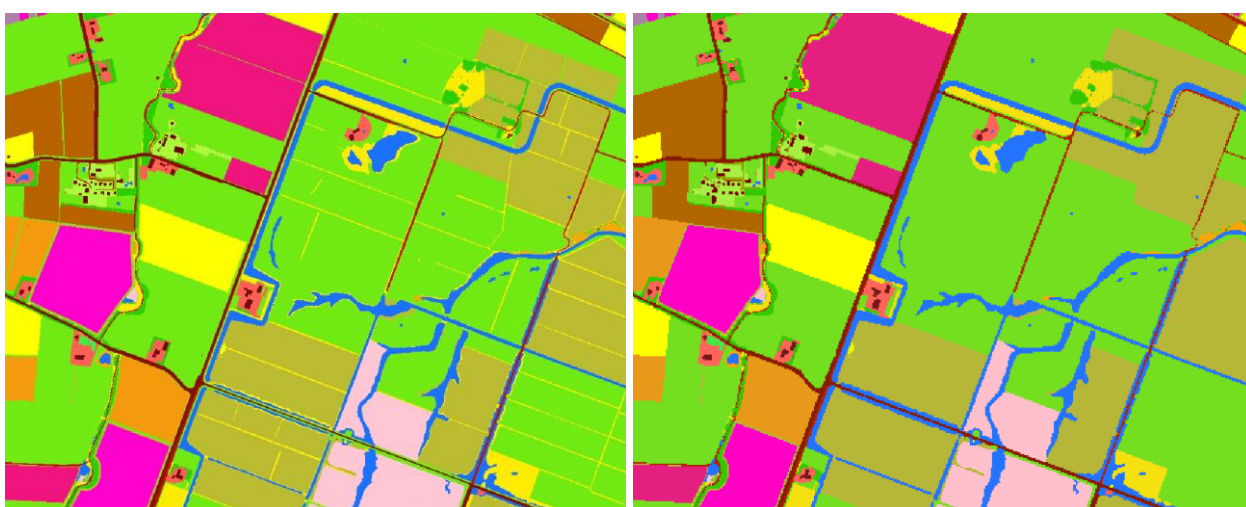
Figuur 7 Het verwijderen van lange, smalle grasstroken m.b.v. postprocessing. Links met agrarisch gras (LGN-klasse 1 – lichtgroen en gras in kustgebied (LGN-klasse 46 – geel) en rechts opgelost in hun omgeving.
